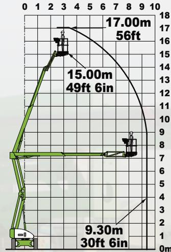
Mit der Height Rider 17 4x4 (HR17 4x4) Ausleger-Arbeitsbühne können zwei Personen mit ihren Werkzeugen in einer Höhe von bis zu 17,20m oder bei einer seitlichen Reichweite von bis zu 9,60m arbeiten. Die vollproportionale Hydrauliksteuerung macht die Bedienung der HR17 4x4 Ausleger-Arbeitsbühne einfach. Die Steuerung ist zuverlässig und einfach zu warten. So werden Ausfallzeiten und Betriebskosten minimiert.
